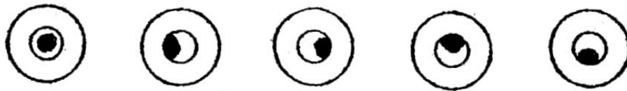
Рис. 95. До визначення похибки компенсації кутів нахилу нівеліра
